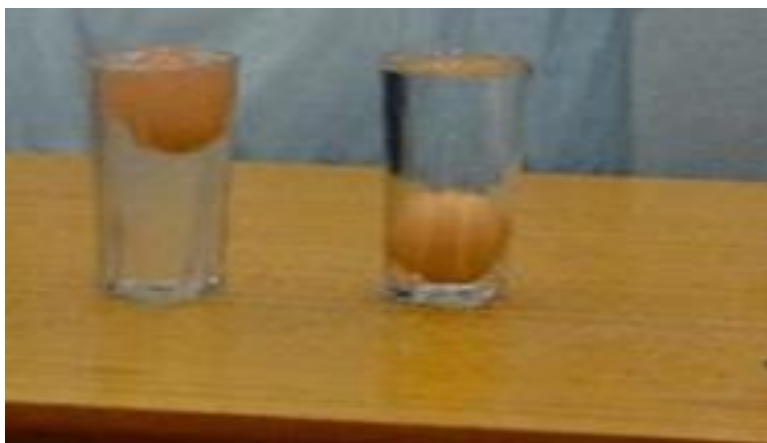
A figura 10 :Dois Copos um com água e sal (direita)- Ovo flutuando, outro apenas com água doce (esquerda)- Ovo afundando. Fonte :Autor da pesquisa,2023
