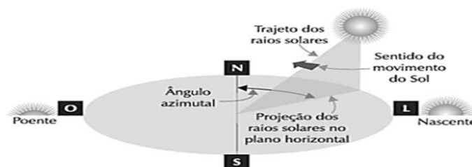
Figura 4.21: Ângulo azimutal. Fonte: Energia Solar fotovoltaica conceitos e aplicações, 2015, p. xxx
